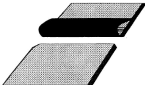
On doit préparer les recouvrements latéraux granuleux longtemps avant que le rouleau suivant ne soit rapproché pour soudure au recouvrement latéral. Si l'enrobage de granules est retardé jusqu'à ce que le rouleau suivant se trouve à moins de 600 mm (24") du recouvrement latéral, le matériel enroulé va être surchauffé par la chaleur résiduelle dégagée par le processus d'enrobage.
